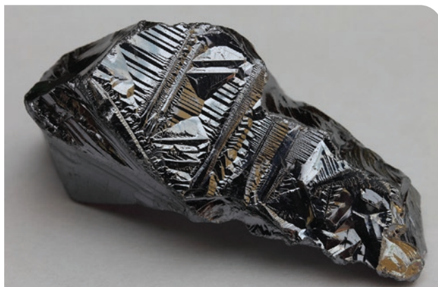
A legismertebb félvezető a szilícium. Ebből vannak a mikroprocesszorok, de az első napelemeket is ebből az anyagból készítették. |Kép: Depositphotos/Fireflyphoto
