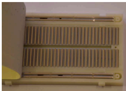
3. ábra: a breadboard összeköttetései alulról
