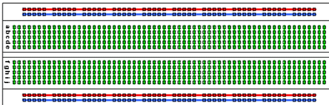
2. ábra: A mérés során használt próbapanel belső összeköttetése
