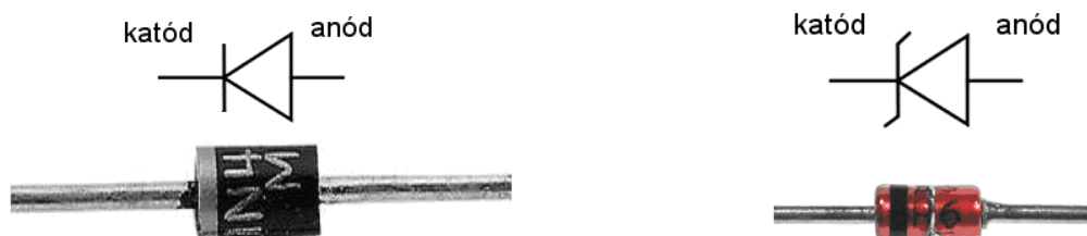
2.1 ábra: 1N4007 normál Si dióda (bal) és Zener-dióda (jobb) bekötése
