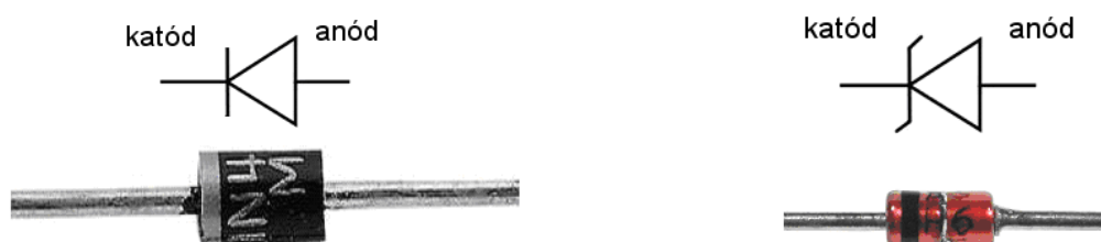
1.1 ábra: 1N4007 normál Si dióda (bal) és Zener-dióda (jobb) bekötése
