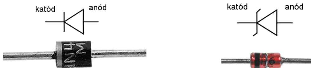
2.1 ábra: 1N4007 normál Si dióda (bal) és Zener-dióda (jobb) bekötése
