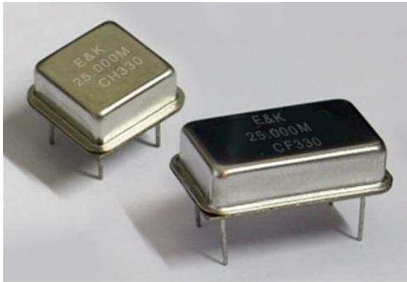
2. ábra: Kvarc oszcillátor és belső felépítése
