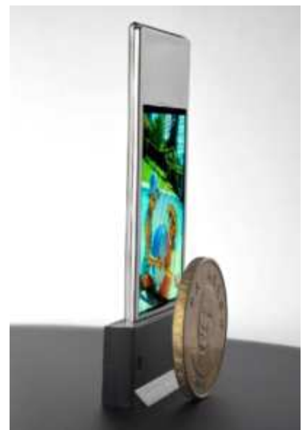
29. ábra – Kétoldalas aktív mátrixos OLED kijelző Jobb oldalon látható, hogy organikus technológiával milyen vékony házban fér el két egymás mögött lévő kijelző
