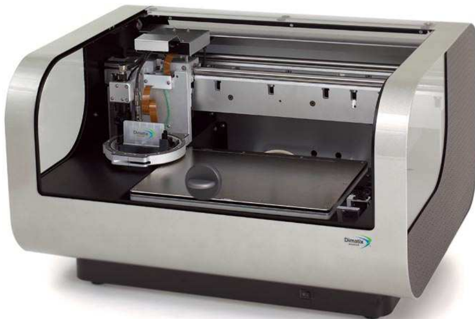
39. ábra –Dimatix nyomtató. A hordozót tartó felület fűthető, valamint vákuummal rögzíti a hordozót (illetve hajlékony anyagoknál ki is simítja).
