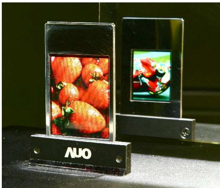
29. ábra – Kétoldalas aktív mátrixos OLED kijelző Jobb oldalon látható, hogy organikus technológiával milyen vékony házban fér el két egymás mögött lévő kijelző
