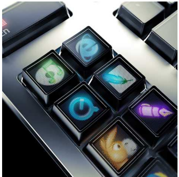
49. ábra – Az Optimus Maximus billentyűzet. Minden egyes gombban egy parányi OLED kijelző található, melyek szabadon konfigurálhatóak egy szoftver segítségével
