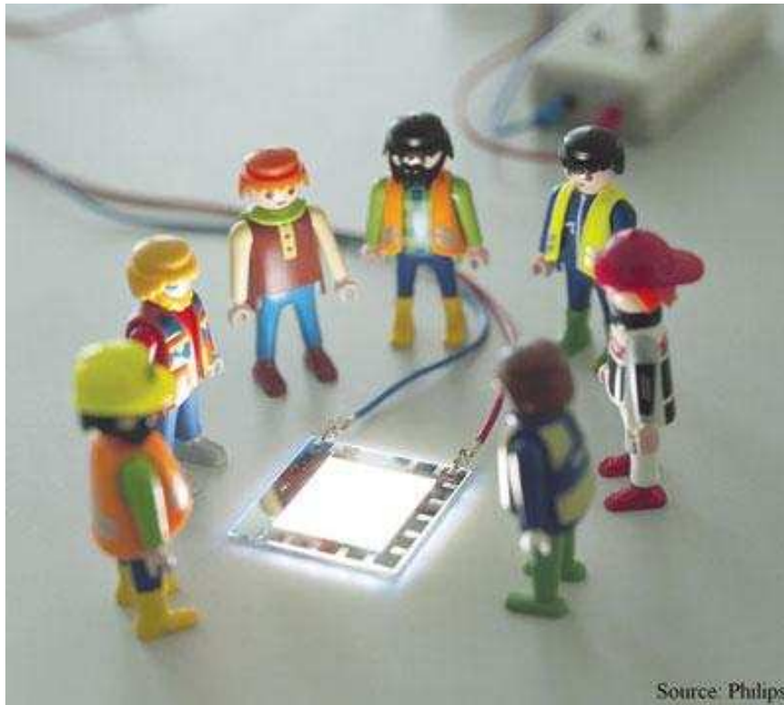
26. ábra - 25 lm/W fényhasznosítású fehér SM OLED cella
