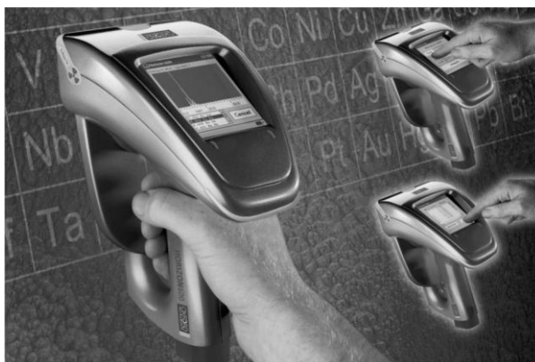
Szén nanocső téremissziós elektronforrással működő hordozható röntgenspektrométer
