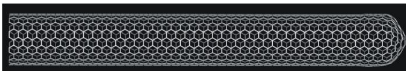
Egyfalu szén nanocső számítógépes modellje.
