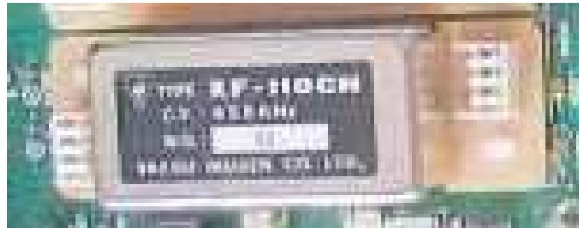
YAESU XF-110CN típusú sáváteresztő kvarcszűrő: 455 kHz frekvencián 250 Hz sáv szélességet biztosít.
