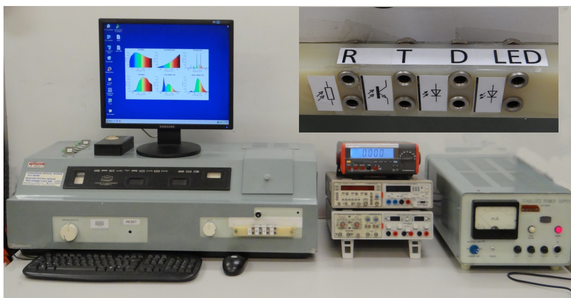
7. ábra A Spektromom 203-as berendezés, valamint a mérés során alkalmazott további műszerek
